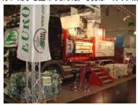
リサイクル技術ではまず廃棄物を圧縮小型化し、低コストで 運搬処理する必要があります。ゴミが出たその地点で低コスト化のための処理が行われることが理想です。工作機械、車はもちろん生活用品に至るまで、ドイツの装置モノはたいてい大型堅牢なのですが、ドイツ企業から、車体に裁断・圧縮装置を搭載して回収現場ですぐに処理できるようにした回収車両が各種出展されました。車両と並んで展示物として目立ったのは、女性や子供でもボタン一つで安全に扱える段ボール
